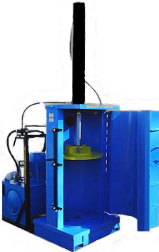
La Prensa Compactadora de Tambores modelo FA-40 y FA-28 están diseñadas para reducir el desecho en más de un 90%, el modelo FA-40 que tiene una fuerza de compactación de 40 Toneladas, reduce el tamaño de un tambor a 75 mm en 38 segundos y el modelo FA-28 que tiene una fuerza de compactación de 28 Toneladas, reduce el tamaño de un tambor a 100 mm en 45 segundos.
