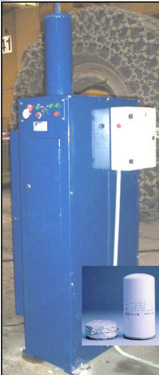
La Prensa Compactadora modelo MS- NA01R para compactar un Filtro posee como parte principal un cilindro de doble efecto que permitirá compactar filtros de diámetro 200 milímetros y alto de 570 milímetros máximo y compactados quedaran de una altura inicial de 50 milímetros aproximado.
